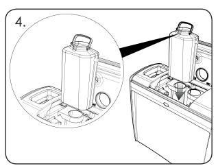
Platzieren Sie den Behälter mit dem Ausguss nach vorne im Behälter zurück.
