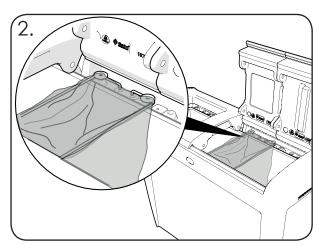
Schritt 3 – Spannen Sie den Sack über die hinteren Befestigungshaken und halten Sie ihn mit dem Elastikband in Position.
