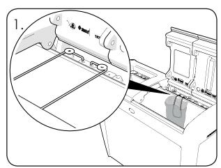
Schritt 1 – Um Müllsäcke im Behälter zu platzieren, lösen Sie das Elastikband von den Befestigungshaken.
