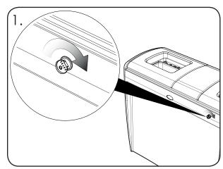
Zum Entriegeln drehen Sie den Schlüssel um 45 Grad im Uhrzeigersinn, bis der Zylinder nachgibt.
