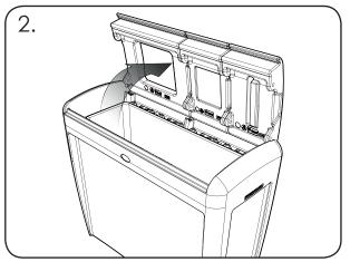
Öffnen Sie den Deckel auf 90°, indem Sie gegen die Sperre drücken, bis der Deckel in einer aufrechten Position steht. Um den Deckel zu schließen, ziehen Sie die Vorderseite des Deckels fest nach unten.
