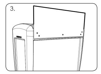
Montieren Sie die Unterlegscheiben (Teil 2) auf die Schrauben (Teil 3) und fixieren Sie diese durch die Löcher am Schild mithilfe des Innensechskantschlüssels (Teil 4).
