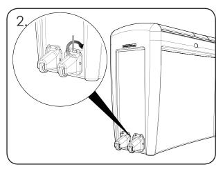
Führen Sie die Schrauben (Teil 2) durch die Löcher und befestigen Sie diese mit dem Innensechskantschlüssel (Teil 3).
