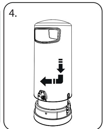
Um den Behälter zu schließen, heben Sie die Haube über den Mülleimer und senken Sie sie, bis sie auf dem Sockel aufliegt. Drehen Sie die Haube im Uhrzeigersinn bis sie in der Sockelschiene einrastet.
