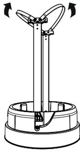
Lösen Sie die Sackhalterung indem Sie die Bänder des Sackes anheben.
