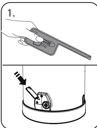
Um den Behälter zu öffnen, sorgen Sie dafür, dass die Abbildung auf dem Schlüssel ganz oben ist. Führen Sie den Schlüssel bis zum Anschlag in das Schloss ein. (Drehen Sie den Schlüssel nicht.) Dadurch wird der Verriegelungsmechanismus freigegeben.
