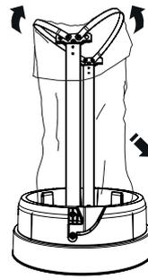
Um den Sack zu entfernen, heben Sie die Sackretentionsbänder.
