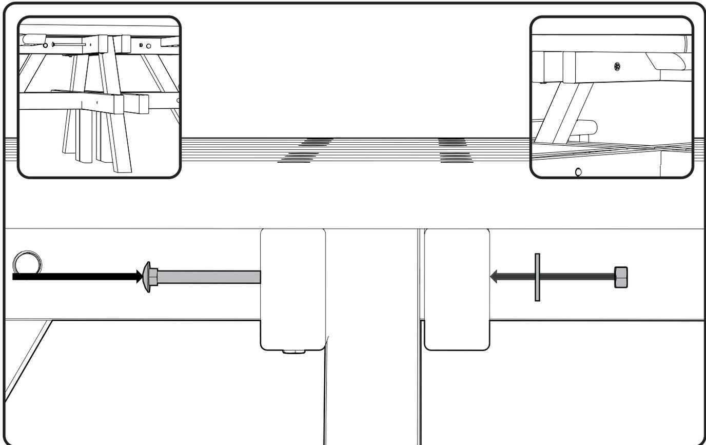
9. Führen Sie die M10 x 180mm Schlossschrauben (Teil 4) durch die Tischplattenhalterung und die Oberfläche der Beine. Beachten Sie, dass Sie die Befestigung durch das kleine Loch einführen, und nicht das größere Senkungsloch. Sichern Sie es mit einer Unterlegscheibe (Teil 5) und Muttern (Teil 6). Nutzen Sie einen 17mm Steckschlüssel, um die Muttern festzuziehen.
