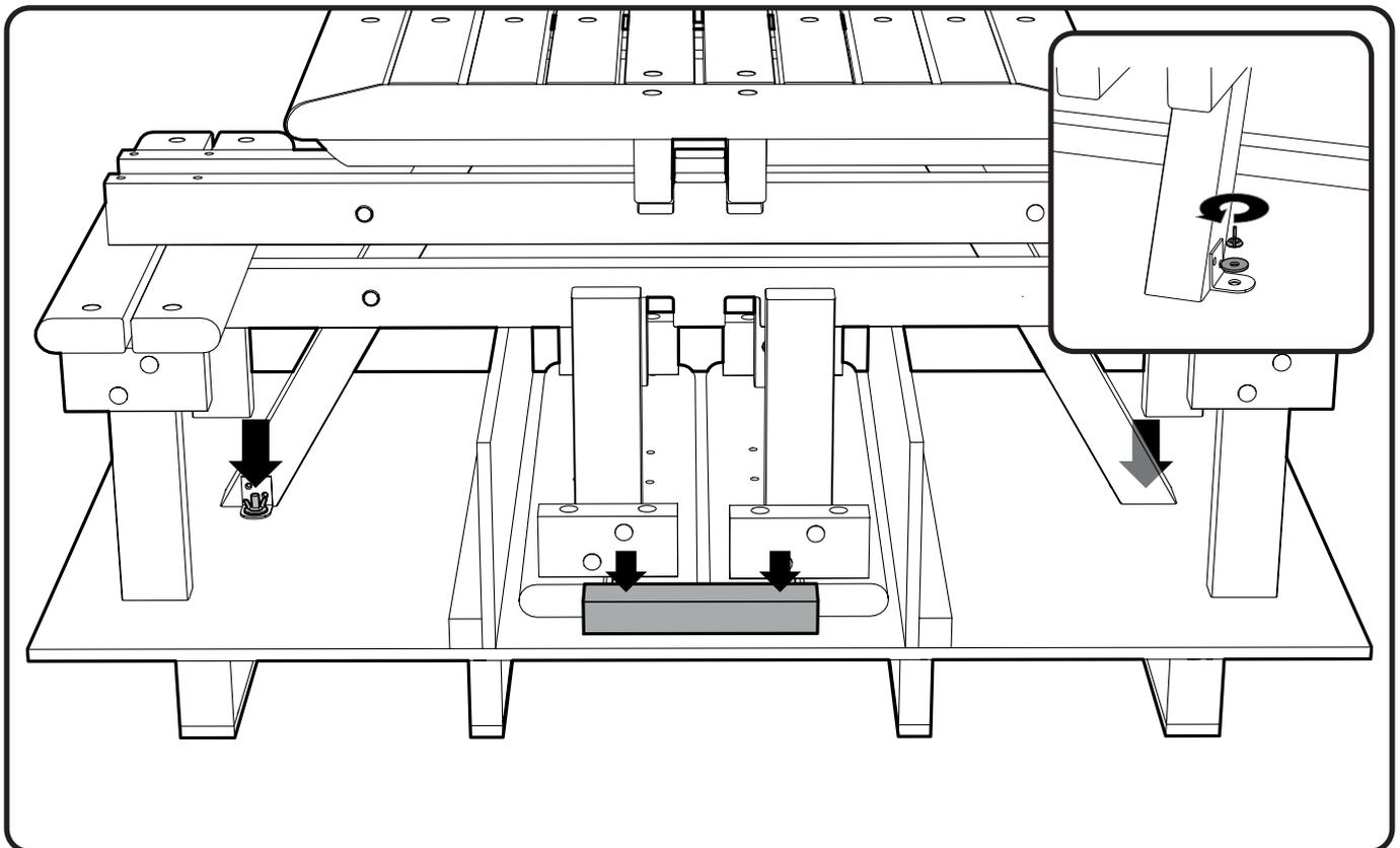
2. Entfernen Sie mithilfe des Akkubohrers oder Schraubenschlüssels die fixierten Haltungen des Holzblocks, welche die Sitze während des Transportes befestigt haben. Entfernen Sie die 2 x Flügelmuttern, die den Tisch an der Palette halten.
