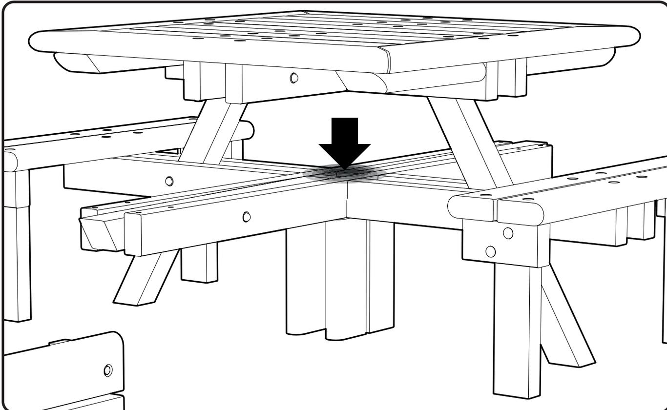
7. Versichern Sie sich, dass die Querlatten komplett eingerastet sind, indem Sie die Querlatte und die Beinmontage vorsichtig mit dem Gummihammer direkt über den Auflageblöcken klopfen bis die Oberflächen der Querlatten eben sind.
