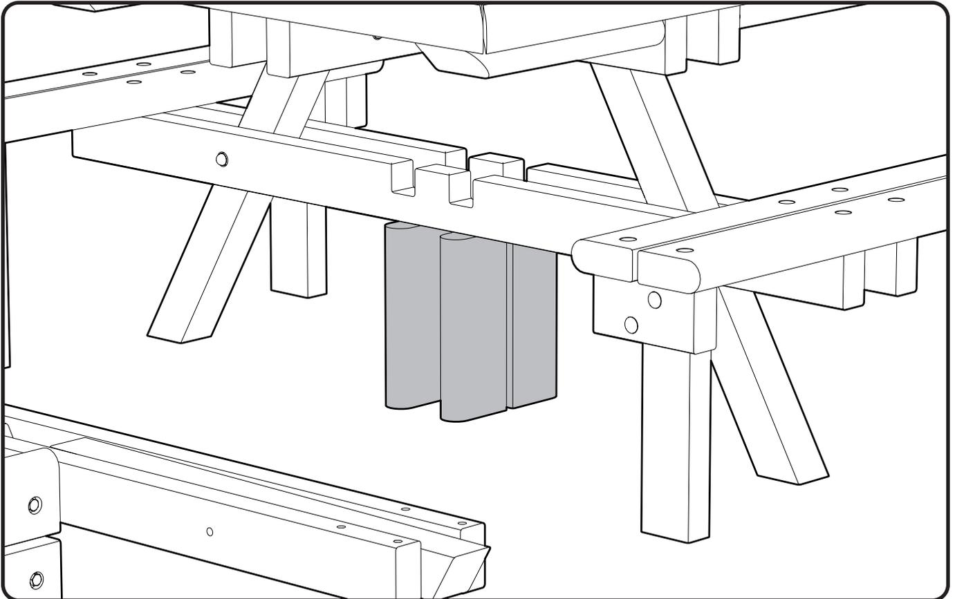
5. Platzieren Sie 4 x Auflageblöcke (Teil 3) zwischen der passenden Querlatte und dem Boden genau neben den Verbindungen.
