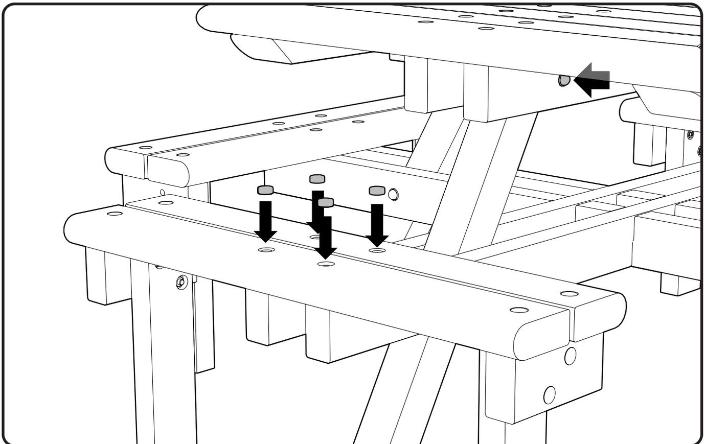
12. Montieren Sie die gewölbten, aufgesteckten Abdeckklappen (Teil 7) über die Muttern und fixieren Sie die Tischbeine in Position (ab Schritt 9). Montieren Sie schließlich die aufgesteckte Abdeckklappe (Teil 8) auf den Sitzbefestigungen (Gummihammer könnte benötigt werden).
