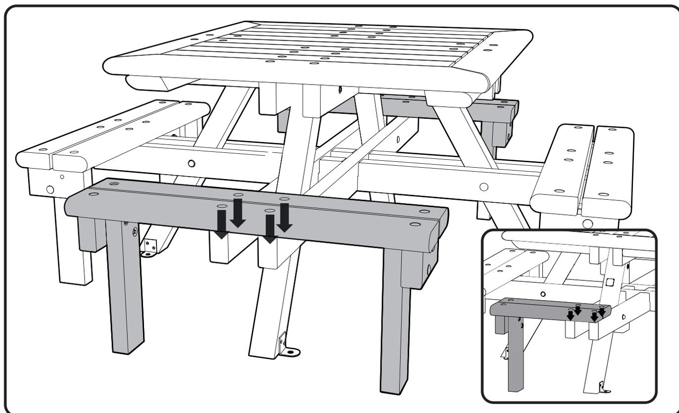
10. Ziehen Sie die Befestigungen am Mittelpunkt der Beine fest. Platzieren Sie die Beinmontage (Teil 2) in Position, wie gezeigt. Richten Sie die vier Löcher in den Sitzen passend mit den Löchern am Ende der Querlatte und der Beinmontage aus.
