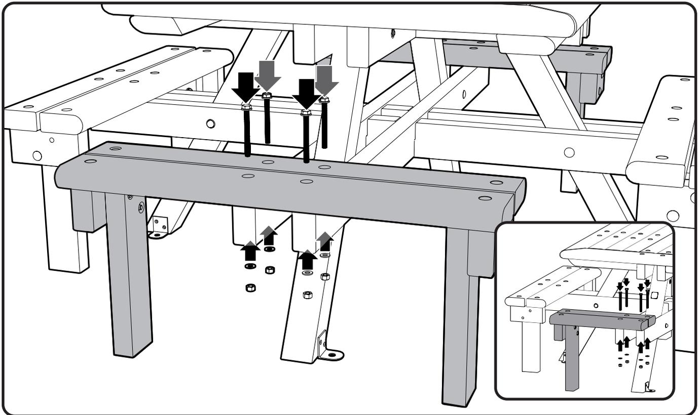
11. Führen Sie 4 x M10 x 130mm Schrauben (Teil 9) durch den Sitz und die Querlatte (Gummihammer kann benötigt werden). Befestigen Sie die Position mithilfe von Unterlegscheiben (Teil 5) und Muttern (Teil 6). Nutzen Sie einen 2 x 17mm Steckschlüssel, um alle Befestigungen festzuziehen. Wiederholen Sie diesen Vorgang für die gegenüberliegenden Sitze.
