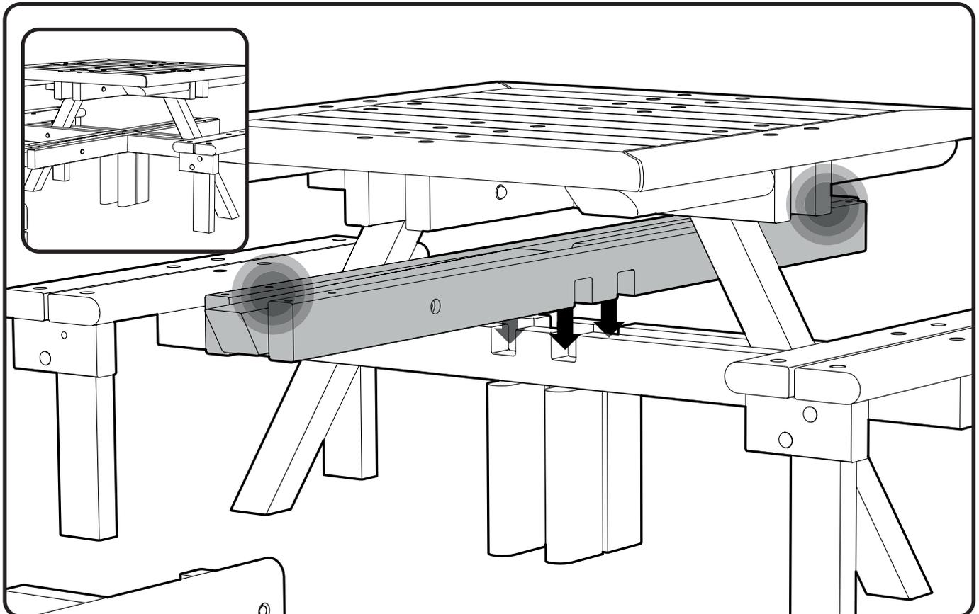
6. Führen Sie die Querlatte und die Beinmontage (Teil 1) durch die Tischpaketmontage und stecken Sie diese in die zugehörigen Verbindungen der passenden unteren Querlatte. Bewegen Sie die Querlatte und die Beinmontage vorsichtig und korrekt mit den Verbindungen in Richtung Boden.
