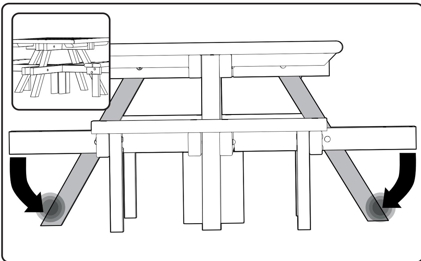
8. Schwenken Sie die Beine abwärts von der Querlatte und der Beinmontage. Richten Sie die Befestigungslöcher zwischen der Spitze des Beines und der Unterseite des Oberrahmens des Tisches aus, indem Sie den Sockel jedes Beines mit einem Gummihammer einklopfen bis diese alle eben sind. Entfernen Sie die Auflageblöcke.
