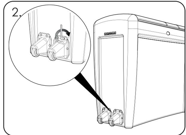
Führen Sie die Schrauben (Teil 2) durch die Löcher und befestigen Sie diese mit dem Innensechskantschlüssel (Teil 3).
