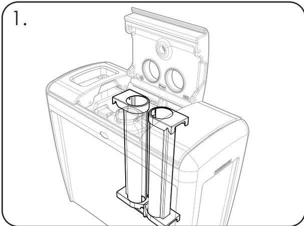
Um den Becherstapler vom Gerät zu entfernen und die Becher zu leeren, öffnen Sie den Deckel.
