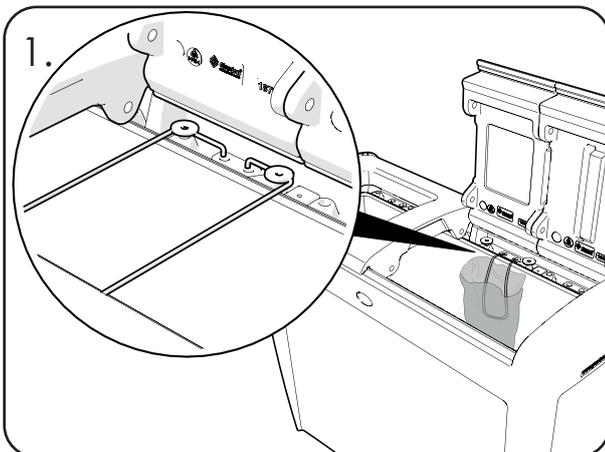
Schritt 1 – Um Müllsäcke im Behälter zu platzieren, lösen Sie das Elastikband von den Befestigungshaken.
