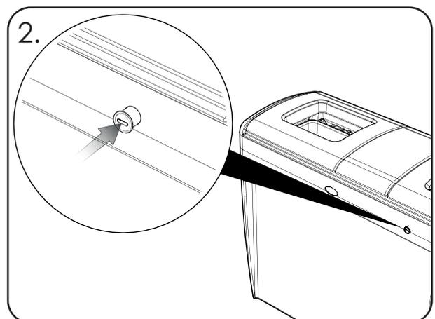
Zum Verriegeln drehen Sie den Schlüssel um 45 Grad gegen den Uhrzeigersinn und drücken Sie den Zylindern hinein.
