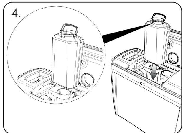
Platzieren Sie den Behälter mit dem Ausguss nach vorne im Behälter zurück.
