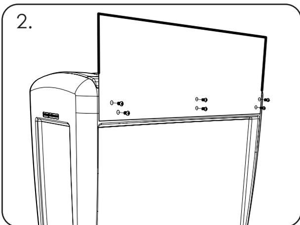
Positionieren Sie das Schild (Teil 1) und richten Sie die sechs Befestigungslöcher an der Rückseite des Behälters aus.
