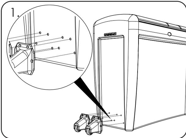
Richten Sie die Räder (Teil 1) entlang den Befestigungslöchern an der Seite des Behälters aus.
