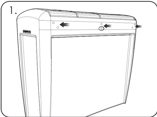
Lokalisieren Sie die Fixierungspunkte an der Rückseite des Behälters.
