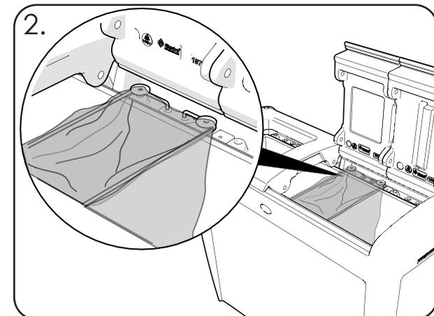
Schritt 3 – Spannen Sie den Sack über die hinteren Befestigungshaken und halten Sie ihn mit dem Elastikband in Position.
