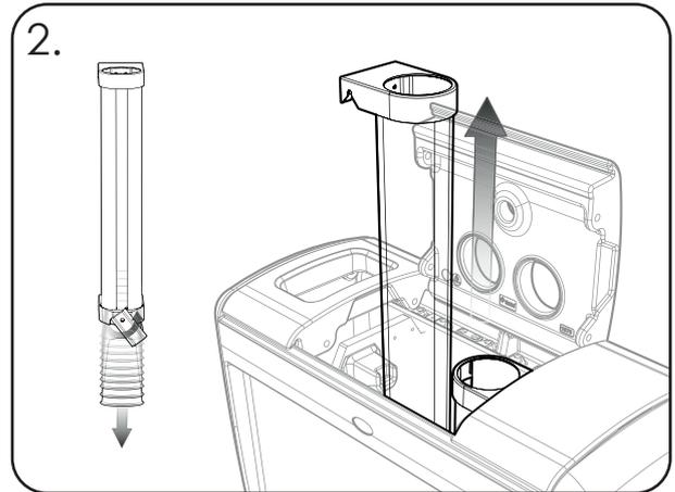
Heben Sie den Stapler aus den Hilfsfixierungen. Nutzen Sie den Schnellspann-Mechanismus, um die Becher zu entfernen. Platzieren Sie den Stapler wieder in den Hilfsfixierungen.
