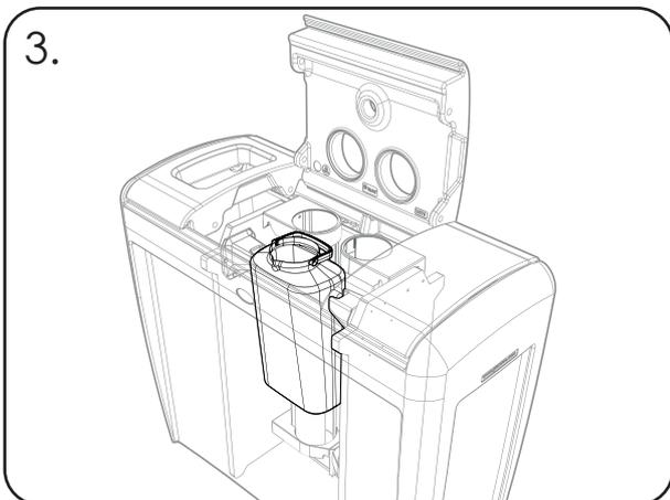
Leeren Sie den Flüssigkeitsbehälter, indem Sie ihn am Griff aus dem Gerät herausheben. Schütten Sie den Inhalt weg.
