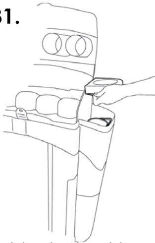
Nachdem der Oberteil des Reservoirs abgenommen worden ist, haben Sie leicht Zugang zu dem Auffangbehälter des Reservoirs.
