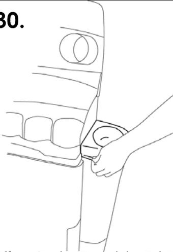
Öffnen Sie den Deckel des Behälters, um danach den Oberteil des Reservoirs mithilfe des Griffes an der Vorderseite abzunehmen.
