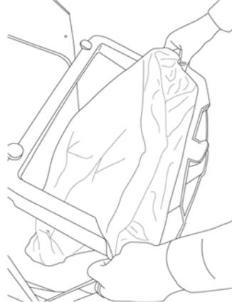
Klemmen Sie einen Sack der korrekten Größe (406 x 727 x 1093 mm – erhältlich von Glasdon) zunächst in die Klemmvorrichtungen an der Vorderseite der Tür ein.
