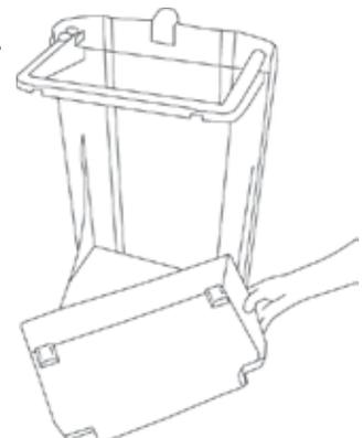
Der Behälter wird mit einer Auffangschale geliefert, die sich im Boden der Tür befindet. Die Schale fängt eventuell auslaufende Flüssigkeiten auf und ist abnehmbar, um diese leicht zu leeren und zu reinigen.
