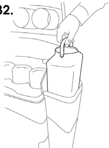
Nehmen Sie den Auffangbehälter aus dem Reservoir mithilfe des Handgriffes aus.
