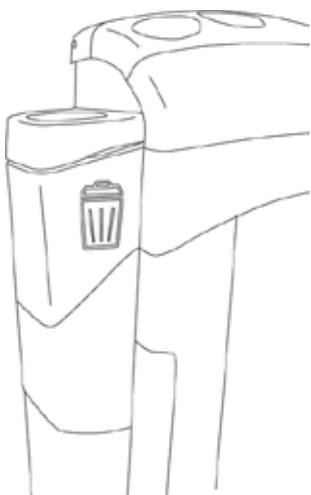
Der seitliche Abfallbehälter wird genauso wie das Reservoir geöffnet.
