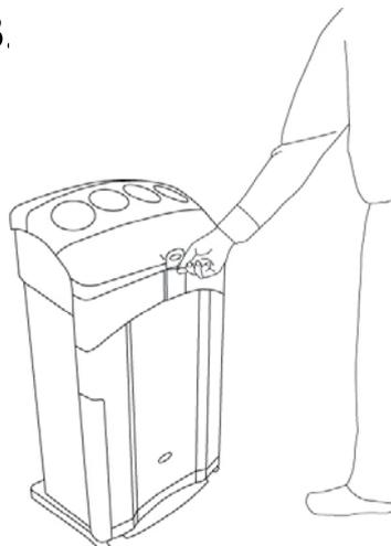
Vergewissern Sie sich, dass der Sack in allen Stapelröhren offen ist und schließen Sie dann den Deckel.
