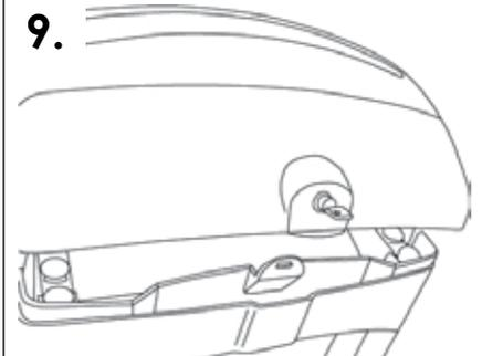
Für Modelle, welche mit Schloss ausgestattet sind, drücken Sie nach dem Schließen des Deckels das Schloss, so dass dieses verriegelt ist.
