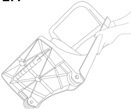
Die Tür des Behälters ist mit zwei Rädern ausgestattet. Somit kann die Tür ohne Anstrengung aus dem Behälter gerollt werden. Dieses erleichtert den Zugang zu dem Müllsack.
