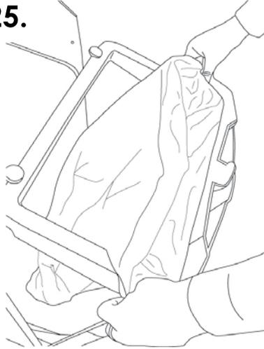
Entfernen Sie den Sack aus den Klemmvorrichtungen an der Vorder- und Rückseite des Einwurfbereiches.
