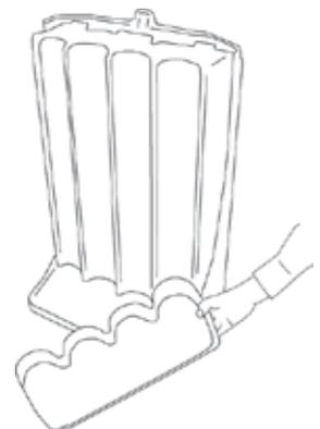
Der Behälter wird mit einer Auffangschalle geliefert, die sich im Boden der Tür befindet. Die Schalle fängt eventuell auslaufende Flüssigkeiten auf und ist abnehmbar, um diese leicht zu leeren und zu reinigen.
