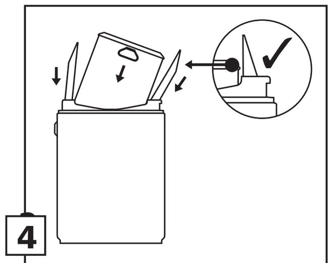
4 Die Ascherbehälter können nun wieder eingesetzt werden. Beachten Sie dabei, dass die höhere, spitze Seite der Behälter nach oben und zur Innenseite des Innenbehälters gerichtet ist (wie in der oberen Abbildung dargestellt). So wird verhindert, dass eine Barriere zwischen den Behältern entstehen kann und Zigaretten eventuell in den Abfallbehälter gelangen.
