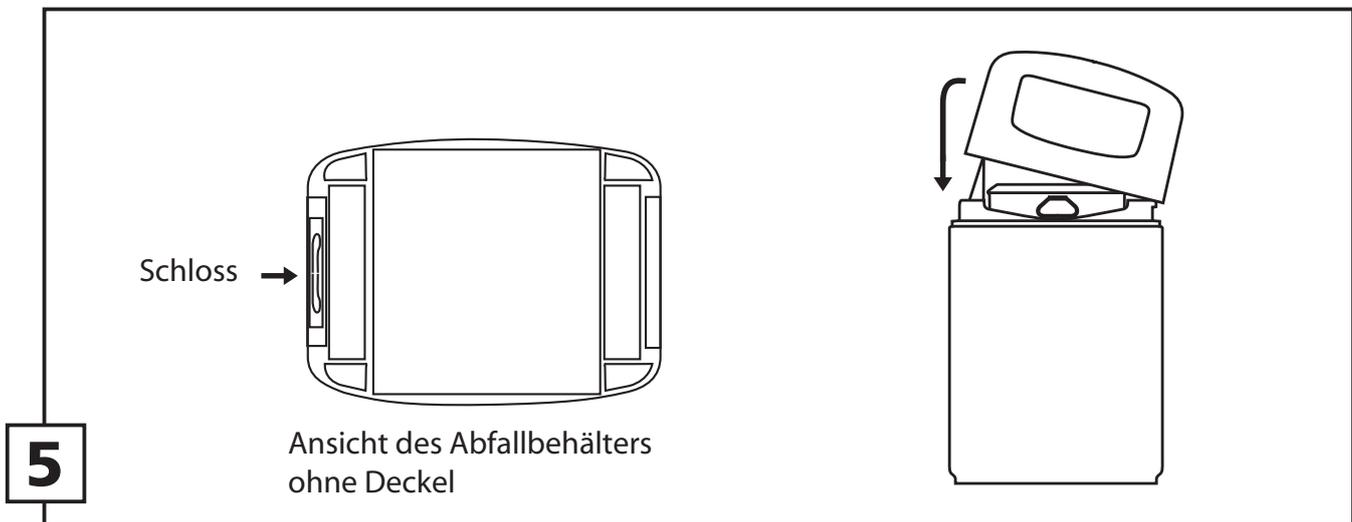
Platzieren Sie beim Wiederaufsetzen des Deckels zuerst die Seite ohne Schloss auf dem Abfallbehälter und lassen diese einrasten, danach lassen Sie die Seite mit dem Schloss auf den Abfallbehälter fallen. Die Verriegelung des Deckels erfolgt automatisch.
