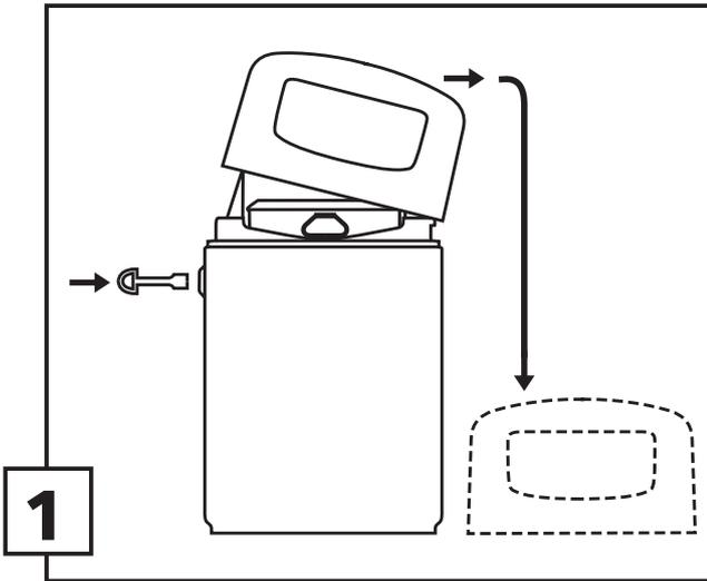
1 Um den Abfallbehälter zu öffnen, stecken Sie den Schlüssel in das Schloss und drehen diesen im Uhrzeigersinn. Heben Sie nun den Deckel, an der Seite des Schlosses, an und entfernen Sie ihn komplett. Legen Sie den Deckel (wie in der oberen Abbildung dargestellt) in dieselbe Richtung ab wie Sie ihn abgenommen haben. So stellen Sie sicher, dass beim Aufsetzen des Deckels die Seite mit dem Schloss wieder an der richtigen Stelle ist.
