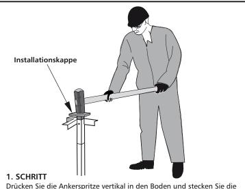
Drücken Sie die Ankerspritze vertikal in den Boden und stecken Sie die Installationskappe auf den Anker.
