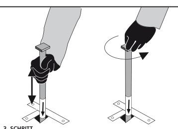
Der Stab wird nun zur Aktivierung des Ground-Lock-Systems in den hohlen Anker eingeführt. Wenn der rote Pfeil auf dem Aufkleber des Stabs mit dem oberen Teil des Ankers auf gleicher Höhe ist, ist das Bodenverankerungssystem völlig eingerastet, d.h. der Widerhaken ist im Boden richtig verankert. Drehen Sie nun den Stab entgegen des Uhrzeigersinns, um ihn vom Block zu trennen. Entfernen Sie jetzt den Stab vom Anker und bewahren Sie ihn für künftige Verwendungen auf.
