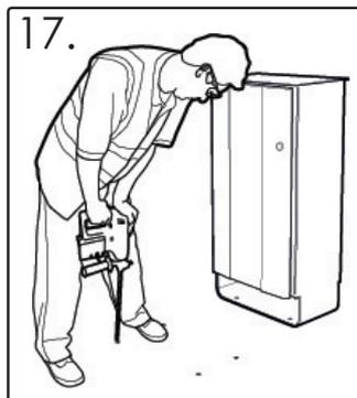
17. Bohren Sie vier Löcher mit einer Mindesttiefe von 80mm mit dem 16mm Steinbohrreinsatz. Entfernen Sie den Betonstaub von den Löchern mit einem Luftgebläse oder einer Bürste.
