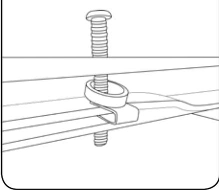
Platzieren Sie den Abstandshalter (TEIL 7) zwischen der Radmutter (TEIL 8) und dem Schild. Fädeln Sie die vorbereiteten Schrauben durch das Schild und ziehen Sie sie von Hand leicht fest.
