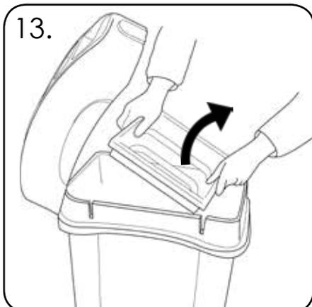
13. Entnehmen Sie die internen Komponenten aus dem Behälter (Siehe Schritte 4-9, um das Entleeren des Behälters zu erleichtern).
