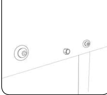
Wiederholen Sie die Schritte 18-19 für beide Befestigungspunkte. Ziehen Sie die Schrauben mit dem Inbusschlüssel fest an.
