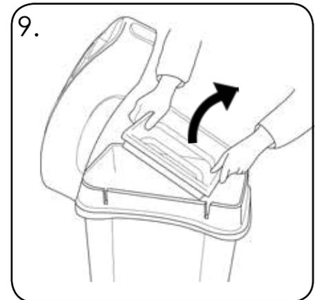
9. Entfernen Sie die interne Aufnahmevorrichtung, indem Sie diese aus den Sackhalteschlitz im Behältergehäuse ziehen.
