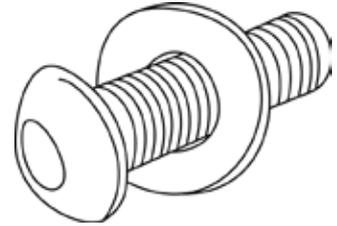
Bereiten Sie die Schrauben wie gezeigt vor, indem Sie die Unterlegscheibe M6 (TEIL 5) auf die Schraube M6 (TEIL 6) stecken.
