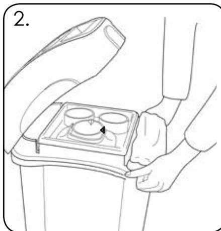
Um Säcke einzuhängen, stecken Sie diese zunächst in die Sackhalteschlitz (TEIL 3) und stülpen Sie sie dann über den äußeren Rand.
