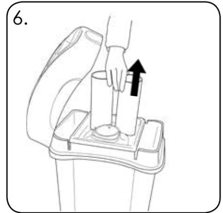
6. Entnehmen Sie die Bechersammelrohre (TEIL 5), indem Sie diese nach oben heben und aus der internen Aufnahmevorrichtung herausziehen.
