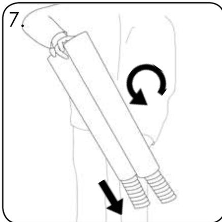
7. Drehen Sie die Bechersammelrohre um 180 Grad, damit die Becherstapel entfernt werden können.
