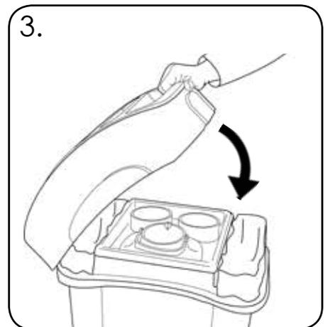
Schließen Sie den Deckel. Achten Sie dabei darauf, dass die Säcke korrekt befestigt sind.
