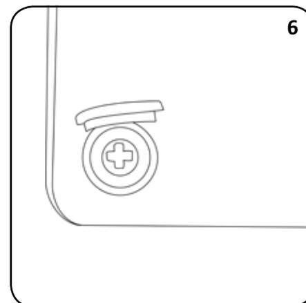
Legen Sie das A4-Schild auf die 4 Befestigungslöcher und schrauben Sie eine der Schrauben in den Dübel. Anschließend befestigen Sie alle 4 Schrauben mit dem Schraubenzieher.
