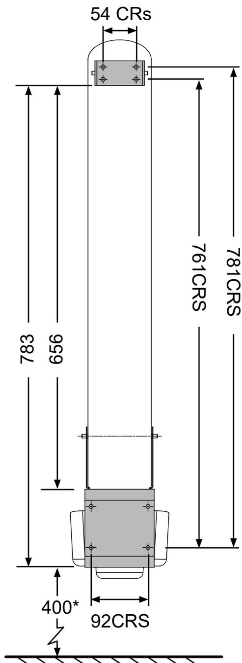
\* DIE HALTERUNG DER TROPFSCHALE SOLLTE IN EINER HÖHE VON 400mm MONTIERT WERDEN
