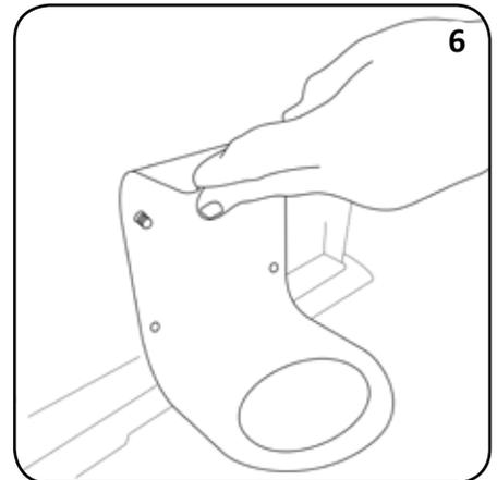
Platzieren Sie TEIL 3 auf TEIL 2. Drücken Sie die Schraube mit der Unterlegscheibe von der Innenseite des Behälters durch eines der vier Befestigungslöcher an der Unterseite des Behälters.
