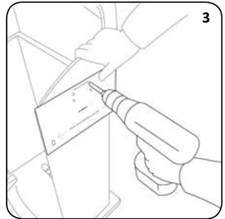
Platzieren Sie Teil 14 auf der rechten Seite des Behälters. Richten Sie die Schablone anhand der Löcher im Körper aus, und stoßen Sie diese mit einem Bleistift durch. Verwenden Sie 2 x TEIL 1 & TEIL 12, um die Schablone vorübergehend zu fixieren.
