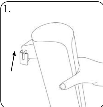
1. Um das Sammelrohr abzunehmen, heben Sie das Rohr von der Bechersammlerhalterung.
