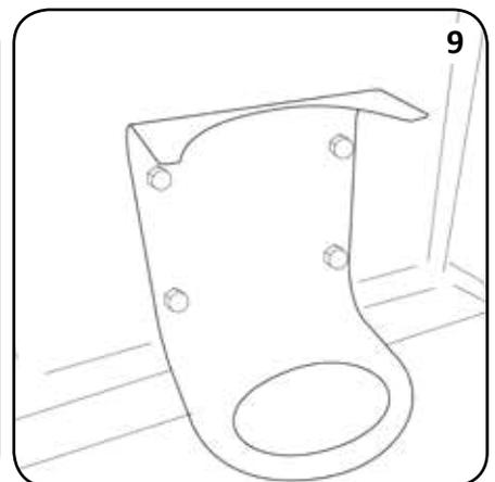
Setzen Sie TEIL 6 auf die Schraube und ziehen Sie diese von Hand an.
