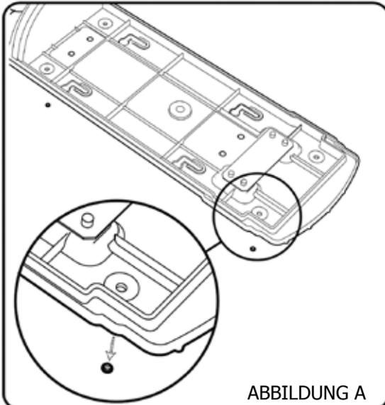
1. Öffnen Sie den Ashmount SG und entfernen Sie den Einsatz. Entnehmen Sie anschliessend wie oben dargestellt die Teilchen aus allen an der Rückseite des Aschers vorgebohrten 4 Löchern (wir empfehlen hierfür die Verwendung eines Schraubenziehers). Positionieren Sie nun den Ashmount an einer Wand und markieren Sie die Löcher mit Hilfe einer Reissnadel (wir empfehlen, den Ascher so zu befestigen, dass dessen Oberteil sich 1.500mm über Boden befindet.)
