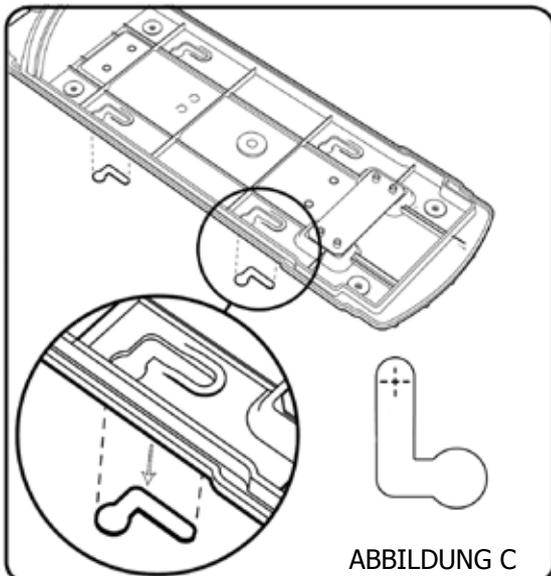
1. Öffnen Sie den Ashmount SG und entfernen Sie den Einsatz. Entnehmen Sie anschliessend wie oben dargestellt die L-förmigen Teilchen aus allen an der Rückseite des Aschers vorgebohrten 4 Einsparungen. Positionieren Sie nun den Ashmount an einer Wand und markieren Sie mit einer Reissnadel den höchsten Punkt jeder L-förmigen Einsparung (siehe obige Darstellung). Wir empfehlen, den Ascher so zu befestigen, dass dessen Oberteil sich 1.500mm über Boden befindet.
