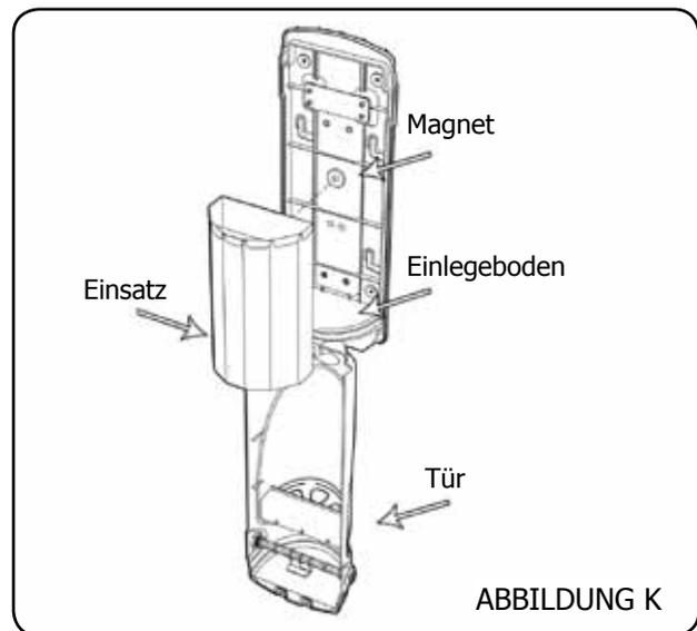
4. Stellen Sie den Einsatz auf den Einlegeboden. Der Magnet an der Rückseite des Aschers hält den Einsatz sicher und fest in Position. Die Tür kann nun geschlossen und mithilfe des Schlüssels verriegelt werden.
