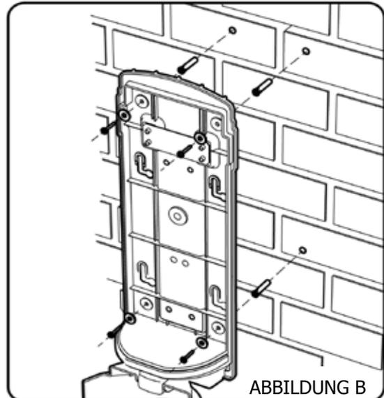
2. Legen Sie nun den Ashmount SG beiseite und bohren Sie mit einem 8mm Bohrer die Löcher. Geben Sie einen Dübel in jedes Loch. Der Ashmount kann nun unter Sicherstellung, dass die Löcher passen, wieder angebracht und mit den mitgelieferten Unterlegscheiben und Schrauben an die Wand geschraubt werden.
