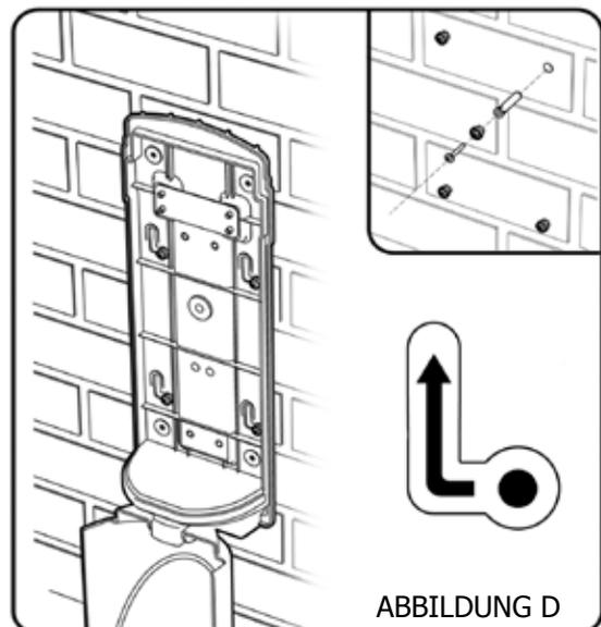
2. Legen Sie nun den Ashmount SG beiseite und bohren Sie mit einem 8mm Bohrer die Löcher. Geben Sie einen Dübel in jedes Loch. Schrauben Sie einen Abstandhalter und eine Schraube in jedes Loch. Der Aschenbecher kann nun auf die überstehenden Schrauben aufgeschoben werden (wie mit den obigen Pfeilen dargestellt) und ist wann immer notwendig entfernbar. Sollten Sie Schwierigkeiten haben, den Aschenbecher anzubringen, dann müssen Sie womöglich die Schrauben leicht lockern.
