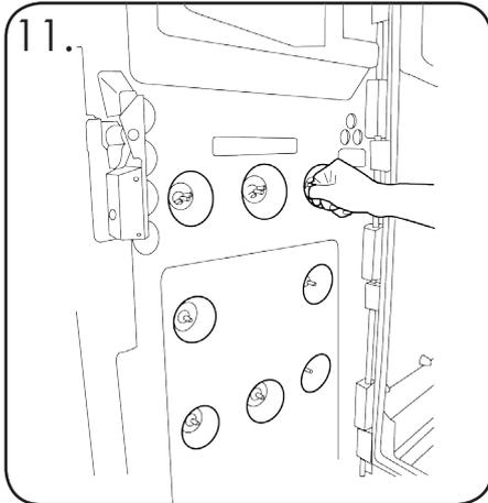
11. Entfernen Sie alle 8 Flügelmutter von der Tür auf der Innenseite des Behälters, indem Sie diese gegen den Uhrzeigersinn herausdrehen.
