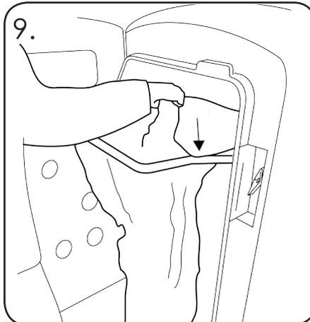
Heben Sie die Sackhaltebänder an und platzieren Sie den Müllsack. Ziehen Sie den Sack über die Sackhaltebänder. Schieben Sie die Sackhalterung in den Behälter um den Sack zu befestigen.
