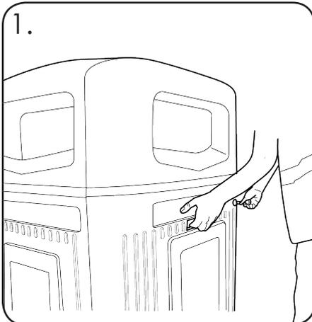
Schlüssel in das Schlüsselloch einführen die Hand an den Griff setzen wie zu sehen.
