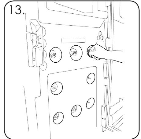
13. Platzieren Sie den Rahmen in der richtigen Position und ziehen Sie die Flügelmutter von der Innenseite des Behälters an. **WICHTIGER HINWEIS:** Mutter nicht zu feste anschrauben.
