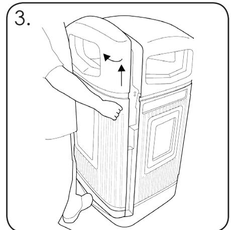
Mit dem Griff heben Sie die Tür an und schwenken Sie diese auf.
