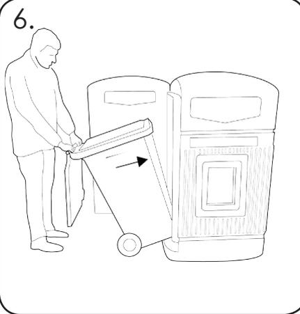
Schieben Sie den Innenbehälter mit Rollen in das Gehäuse, so dass dieser in den vorgegebenen Punkten fest sitzt.
