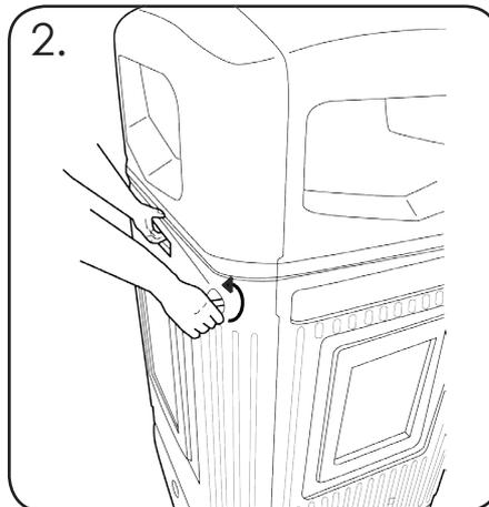
Den Schlüssel gegen den Uhrzeigersinn drehen bis er sich nicht mehr weiterdrehen lässt.
