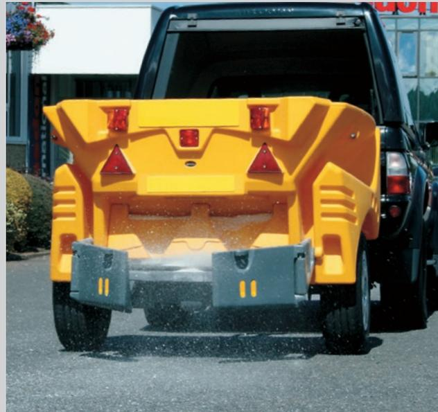
MIT DEM CRUISER 1000 KANN, DANK DER SEITLICHEN ABLENKVORRICHTUNGEN, MIT WENIGEN HANDGRIFFEN VOM BREITFLÄCHIGEN STREUEN ZUR FALLSTREUUNG GEWECHSELT WERDEN.
