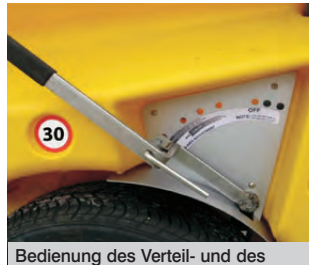
Bedienung des Verteil- und des Abstellmechanismus
