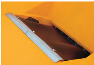
Bewegte Gummimatte für eine gleichmäßige Zuführung des Streugutes
