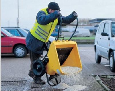
Verteilerscheibe aus Polypropylen geschützt von einem Stahlrahmen.
